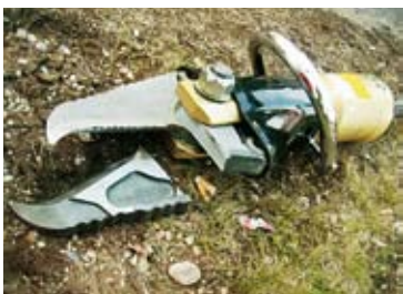
Verstärkte Fahrzeugsäule (oben), daran zerbrochene Rettungsschere
